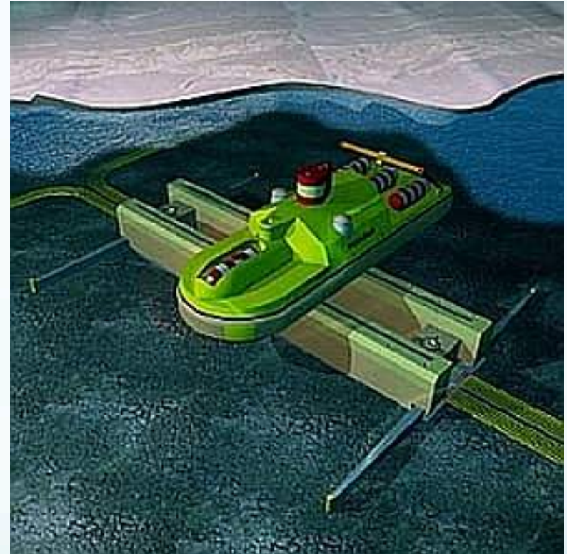
Drillship sitting on a Bottom Template. Source: https://www.cdb-lazurit.ru/en_burovie_kompleksi.html
